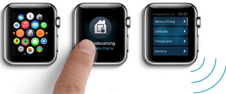
Smartphones, Tablets und Smartwatches werden zur praktischen Fernbedienung, dank Busch-ControlTouch®. Es verbindet die KNX-Installation mit dem IP-Netzwerk und ermöglicht die Steuerung aller KNX-Funktionen im Gebäude. Applikationen für iOS und Android sorgen für eine intuitive Bedienung. So können Schalter, Dimmer, Jalousien, Szenen, IP-Kameras, UPnP-Geräte (zum Beispiel Sonos-Wireless-Boxen), Philips-Hue-Leuchten und vieles mehr in das System eingebunden werden.
