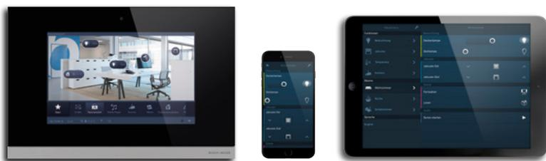
KNX-Bedienelemente bilden die Schnittstelle zwischen dieser hochmodernen Technologie und dem Nutzer. Gleichzeitig sorgen sie für einen Gewinn an Komfort und Sicherheit. Sie regeln Licht, Wärme, Frischluft und die Jalousiesteuerung. Auch Unterhaltungsmedien und das Internet können integriert werden.
